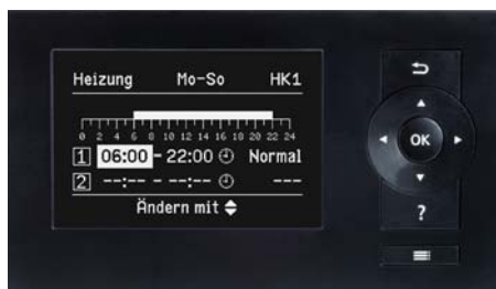
Vitotronic Regelung – leichte Bedienung dank einfacher Navigation und großem, klar ablesbarem Display, zum Beispiel zum Einstellen der Schaltzeiten.
